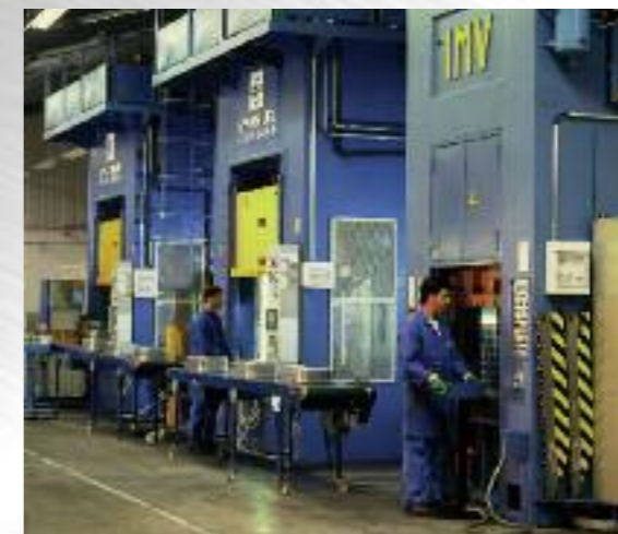
2 presses hydrauliques et 1 presse mécanique en ligne 2 Presse idrauliche e 1 pressa meccanica nella linea di produzione
