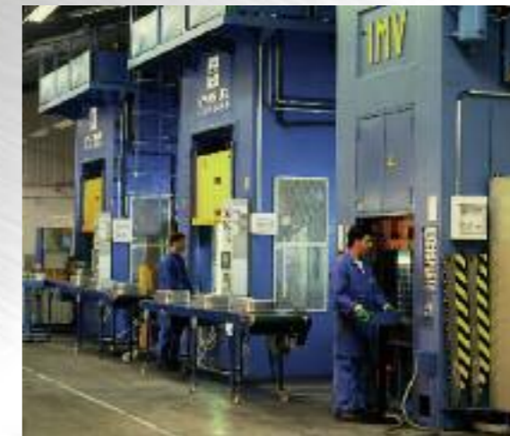
2 presses hydrauliques et 1 presse mécanique en ligne Hydraulische und mechanische Pressen in einer Linie
